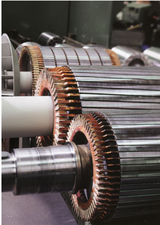
Sonderläufer mit Kupferkäfig zur Erhöhung des Wirkungsgrades
