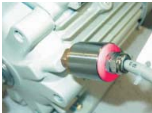
Fehlerhaftes Lager / Faulty Bearing
